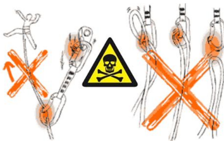
Fig. 3 - Posizionamento del rinvio nel caso di linea di salita verticale.
